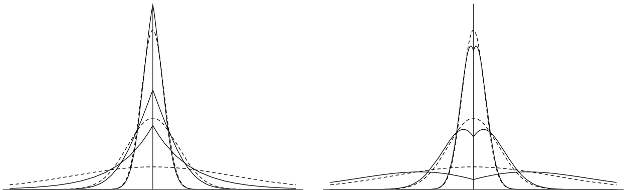
Figure 5: Les courbes pointillées montrent l'évolution temporelle de la distribution (normalisée) de position de la marche non-perturbée, pour les temps t = 0.1, 0.5 et t = 5 . (a) Les courbes pleines à gauche montrent l'évolution de la distribution correspondant à la perturbation par b = +1 , et pour les mêmes valeurs de t . La courbe du bas, correspondant à t = 5 , se confond déjà avec la courbe asymptotique pour t \rightarrow \infty . (b) Les courbes pleines de droite représentent les distributions pour b = -1 , toujours pour les mêmes valeurs de t . Lorsque t augmente, la courbe pleine s'aplatit et devient identiquement nulle pour t = +\infty .
